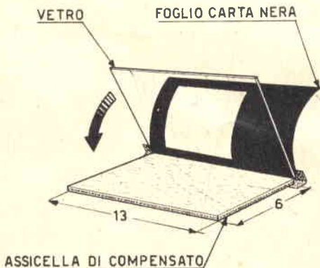
Fig. 3b - Semplice torchietto, costituito da un vetro trasparente, un'assicella di legno e un foglio di carta nera.
